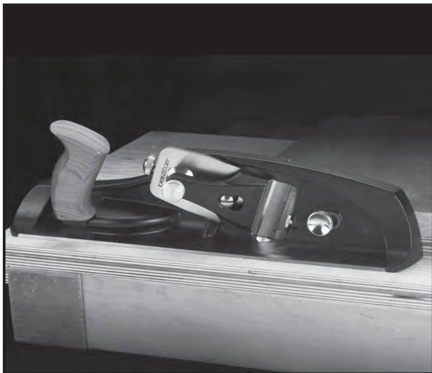
La Shooting plane Veritas® è progettata appositamente per l'uso con una guida autocostruita (Shooting-board) per portare a misura e squadrare i fianchi delle tavole; pesa 3,5 kg, quindi ha un'inerzia sufficiente a tagliare facilmente le fibre di testa. Il corpo è lungo circa 40,5 cm e la base è larga 54mm. Questa pialla è compatibile con la chute board n. 52 Stanley.
